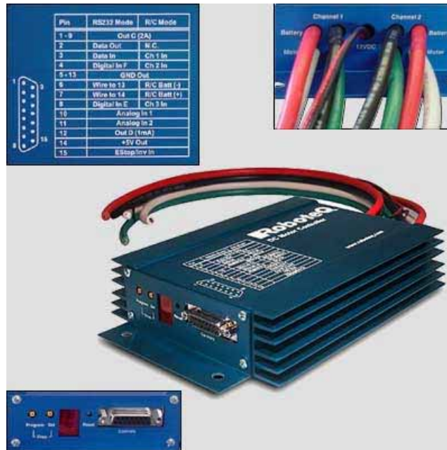
Figura 12: Controlador de Motores.
