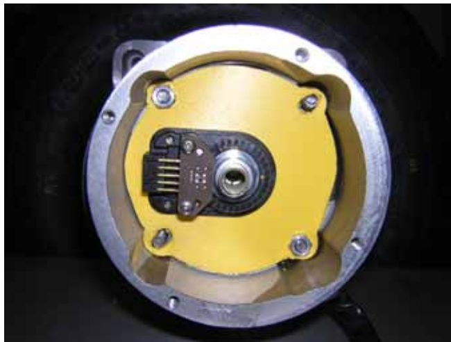
Figura 11: Montaje del encoder
